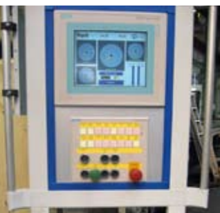
Vergleich Bedientablett Bleiwalze vor 25 Jahren (o.) und mit dezentraler Peripherie (Profibus-DP) von Siemens
