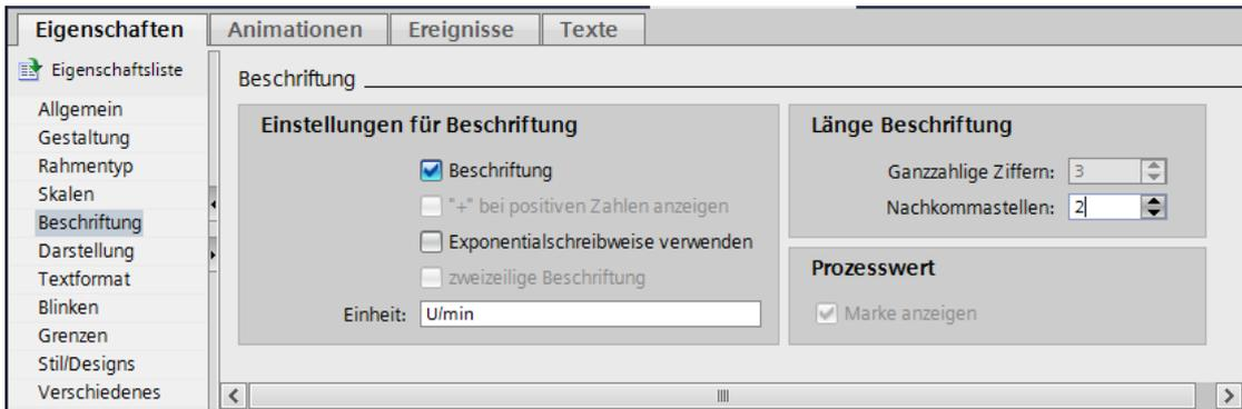
→ In den „Eigenschaften“ bei „Darstellung“ passen Sie die Position und die Größe des Balkens unter → „Position & Größe“ an. Oberhalb des Balkendiagramms fügen Sie zur Beschreibung ein → „Textfeld“ **A** ein mit dem Text → „Drehzahlwert“.
