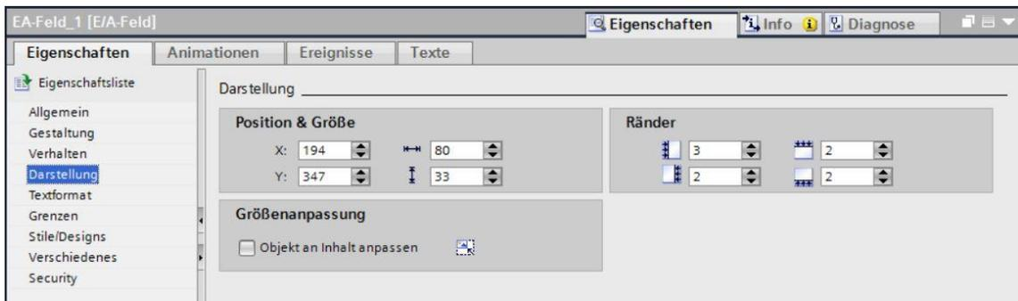
→ Zur Beschreibung fügen Sie jetzt noch aus den Werkzeugen bei → „Basisobjekte“ ein → „Textfeld“ **A** per Drag & Drop hinter dem E/A-Feld ein. Dort tippen Sie die Texte → „Istwert Drehzahl“ und → „U/min“ ein.
