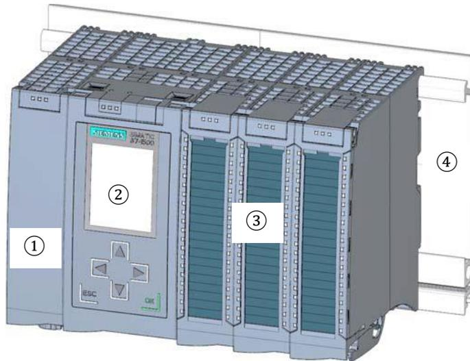
Il controllore programmabile (PLC) controlla e comanda una macchina o un processo con il programma S7. Nel programma S7 le unità I/O vengono interrogate attraverso gli indirizzi di ingresso (%I) e indirizzate dagli indirizzi di uscita (%Q).
