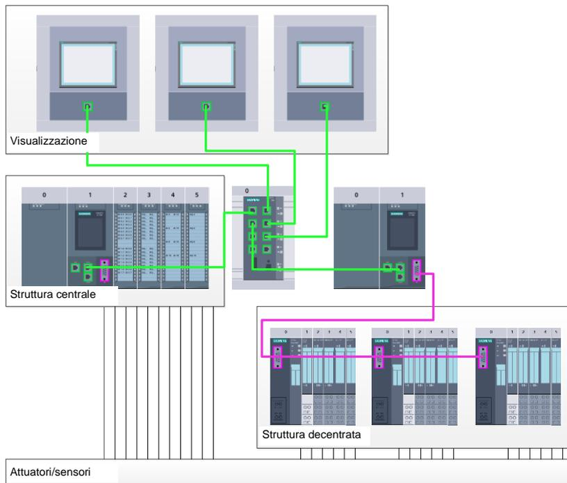
Figura 1: esempio di configurazione hardware con struttura centrale e decentrata
