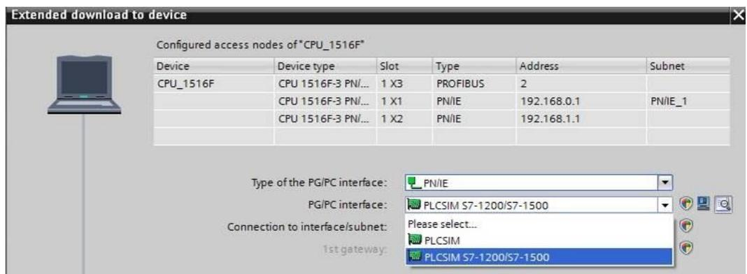
→ Collegamento con l'interfaccia/la sottorete → "PN/IE\_1"
