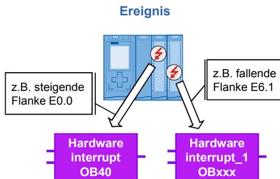
In folgender Abbildung sehen Sie die Konfiguration eines „Prozessalarms“ („Hardware Interrupt“) in der Hardware-Konfiguration einer digitalen Eingangsbaugruppe.
