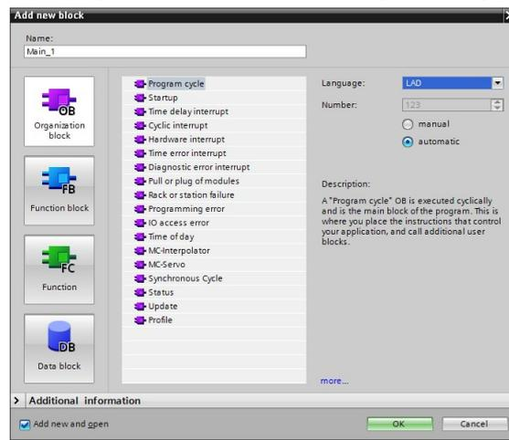
OBs bilden die Schnittstelle zwischen dem Betriebssystem und dem Anwenderprogramm. Sie werden vom Betriebssystem aufgerufen und steuern z. B. folgende Vorgänge:
