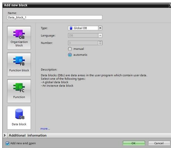
In Datenbausteinen befinden sich variable Daten, die dem kompletten Anwenderprogramm zu Verfügung stehen.
