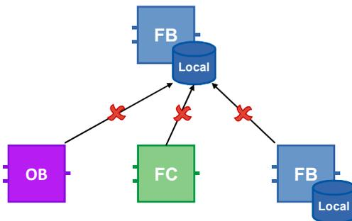
Wenn nur die Schnittstellen der Bausteine zum Datenaustausch verwendet werden, ist gewährleistet, dass alle Bausteine unabhängig voneinander eingesetzt werden können.
