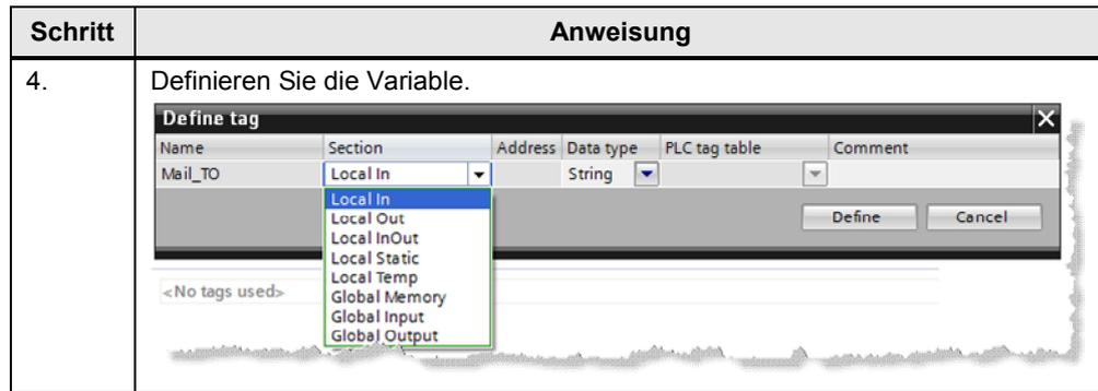
Falls Sie mehrere Variablen in einem Netzwerk definieren wollen, gibt es eine elegante Methode Zeit zu sparen: Vergeben Sie zuerst alle Variablennamen. Definieren Sie dann alle Variablen mit dem Dialog von Schritt 4 gleichzeitig.
