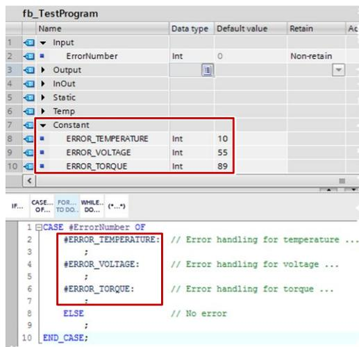
Abbildung 2-20: Globale Anwenderkonstante einer Steuerung
