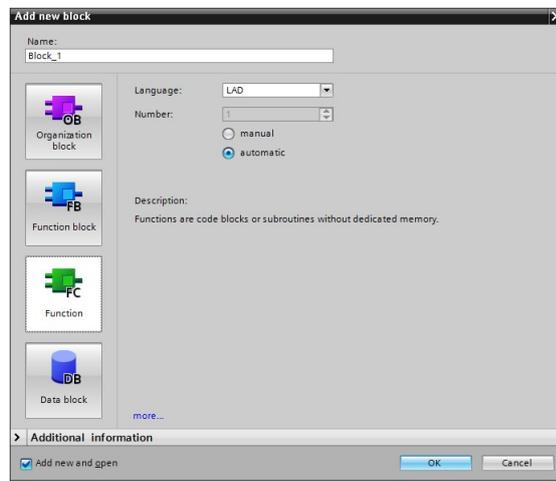
FCs sind Bausteine ohne zyklischen Datenspeicher. Deshalb können Werte von Bausteinparametern nicht bis zum nächsten Aufruf gespeichert werden und müssen beim Aufruf mit Aktualparameter versorgt werden.
