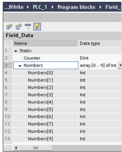
Mit einem Index (array [„index“]) können Sie auf einzelne Elemente im ARRAY indirekt zugreifen.
