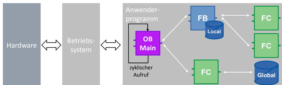
Bei SIMATIC Steuerungen wird das Anwenderprogramm immer zyklisch ausgeführt. Der Zyklus-OB „Main“ ist bereits im Ordner „Programmblöcke“ („Program blocks“) vorhanden nach dem eine Steuerung in STEP 7 angelegt wurde. Der Baustein wird von der Steuerung abgearbeitet und in einer Endlosschleife wieder aufgerufen.
