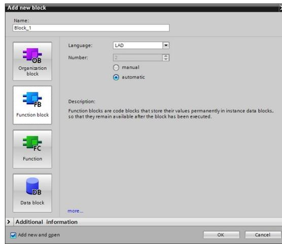
FBs sind Bausteine mit zyklischem Datenspeicher, in dem Werte dauerhaft gespeichert werden. Der zyklische Datenspeicher ist in einem Instanz-DB realisiert.
