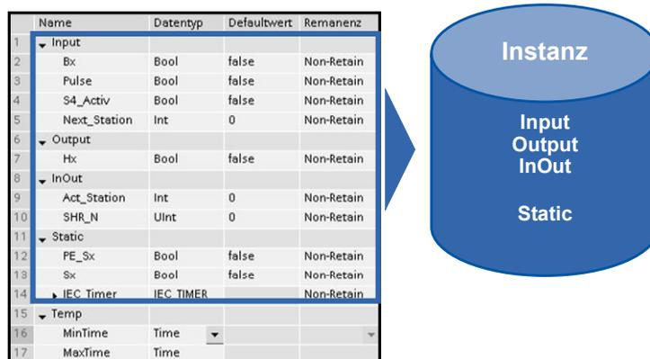
Der Instanz-DB besteht aus einem dauerhaften Speicher mit den Schnittstellen Input, Output, InOut und Static. In einem flüchtigen Speicher (L-Stack) werden temporäre Variablen gespeichert. Der L-Stack ist immer nur für einen Zyklus gültig. D.h. temporäre Variablen müssen in jedem Zyklus initialisiert werden.
