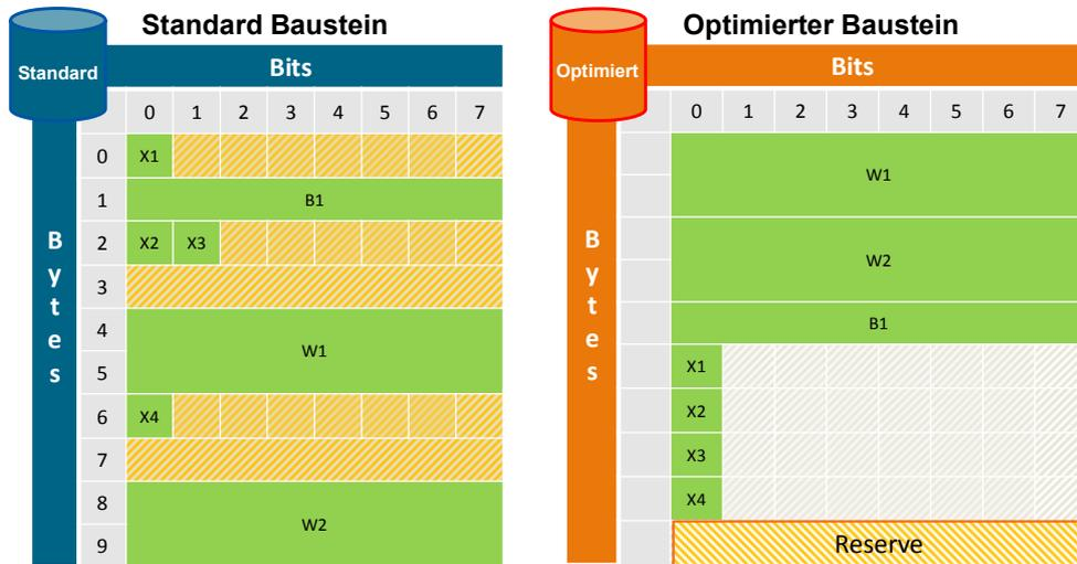
Abbildung 2-7: Speicherbelegung bei optimierten Bausteinen
