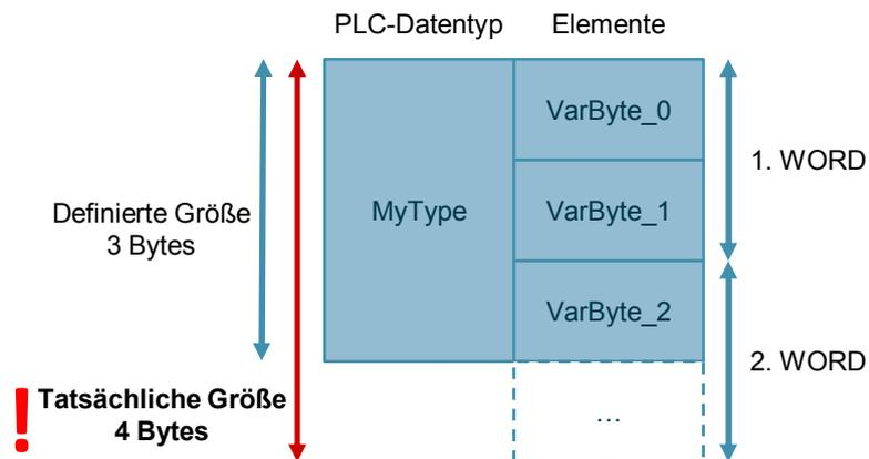
Abbildung 3-32: PLC-Datentyp auf E/A Bereich
