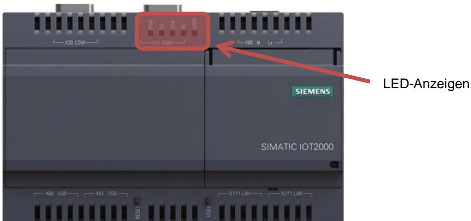
Die LEDs auf der Vorderseite des Gerätes zeigen den Betriebszustand an:
