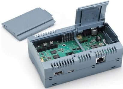
In jeder Ausführung steht ein Arduino UNO kompatibler Header zur Verfügung, über den beliebige Arduino Shields in Betrieb genommen werden können. Es besteht auch die Möglichkeit, eigene Shields zu entwickeln und einzusetzen.
