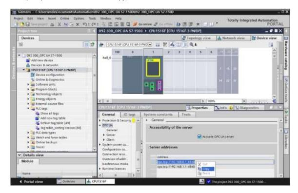
→ Paste the previously copied OPC UA server address of the CPU 1516F into SIMIT as "OPC UA Server URL" under "Couplings", "OPC UA client". (→ SIMIT → Couplings → OPC UA Client → Properties → OPC UA Server URL → Paste)
