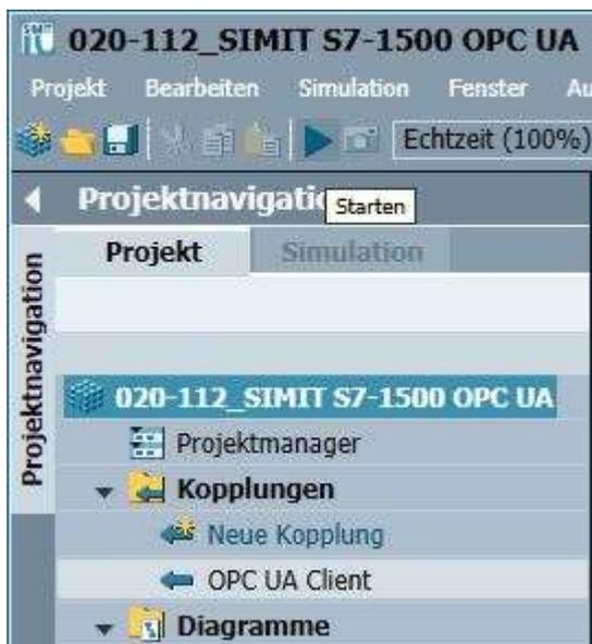
→ Nach dem Start der Simulation können Sie in SIMIT den Zugriff auf die Eingänge und Ausgänge der S71500-Station testen.
