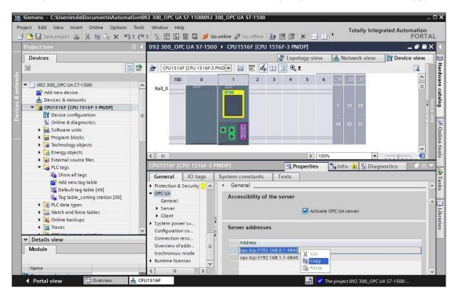
→ Paste the previously copied OPC UA server address of the CPU 1516F into SIMIT as "OPC UA Server URL" under "Couplings", "OPC UA client". (→ SIMIT → Couplings → OPC UA Client → Properties → OPC UA Server URL → Paste)
