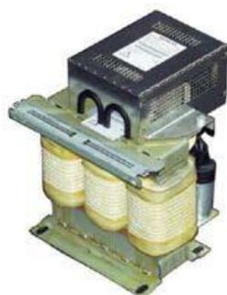
变频器输出端上的正弦滤波器用于限制电机绕组上的电压陡度和电压峰值。允许的最大电机线长度提高到 300 m。不必加输出电抗器。
