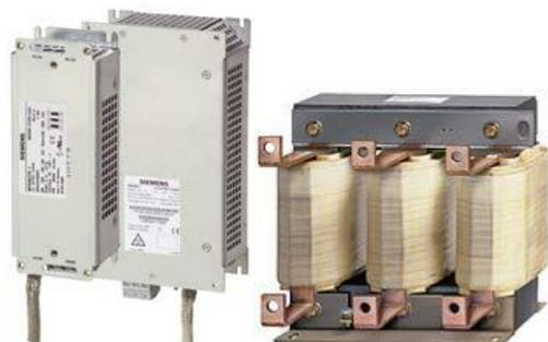
输出电抗器通过线路中的容性电流降低电机绕组的电压负载和变频器的负载。如果是屏蔽的电机线, 50 m 以上需要加输出电抗器, 如果是非屏蔽, 则 100 m 以上才需要加。
