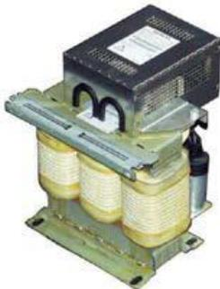
Il filtro sinusoidale sull'uscita del convertitore limita la potenza della curva della tensione e le tensioni di picco sugli avvolgimenti del motore. La lunghezza cavi motore max. consentita viene incrementata di 300 m. La bobina di uscita si rende superflua.
