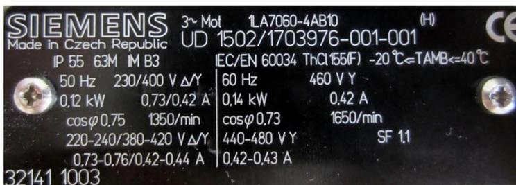
Figura 1: Targhetta di identificazione Motore asincrono
