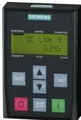
Il **BOP-2** è un Operator Panel predisposto per l'innesto a scatto sulla Control Unit. Il BOP-2 è provvisto di un display a due righe per la diagnostica e il comando del convertitore.
