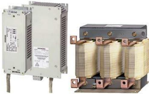
Le bobine di uscita riducono il carico di tensione degli avvolgimenti motore e il carico del convertitore tramite correnti capacitive di trasferimento del carico nei cavi. La bobina di uscita è necessaria in cavi motore schermati da 50 m oppure da 100 m non schermati.
