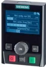
L'**Intelligent Operator Panel (IOP)** è disponibile con innesto a scatto per la collocazione sulla Control Unit oppure come unità hand held con cavo di collegamento alla Control Unit. L'IOP consente il comando e la diagnostica del convertitore.
