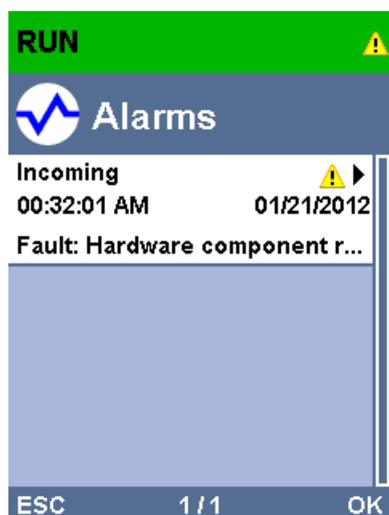
图 2: CPU 1516F-3 PN/DP 的显示屏, 带系统诊断报警文本
