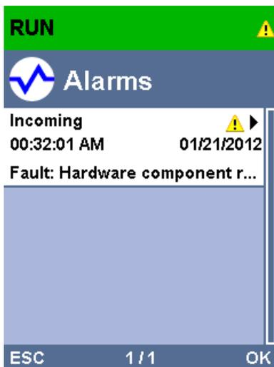
Figure 2 : Écran de la CPU 1516F-3 PN/DP avec texte de message provenant du diagnostic système
