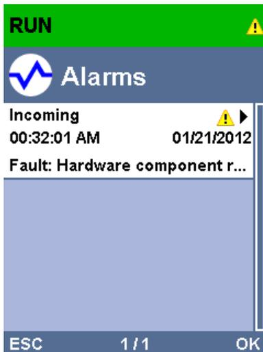
Figura 2: Display de la CPU 1516F-3 PN/DP con texto de aviso del diagnóstico del sistema
