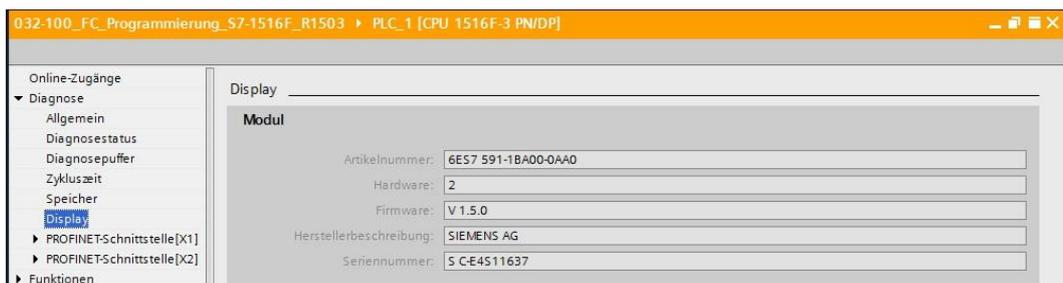
→ Die Netzwerk-Einstellungen und der Zustand der PROFINET-Schnittstellen [X1] bzw. [X2] können ebenfalls angezeigt werden.
