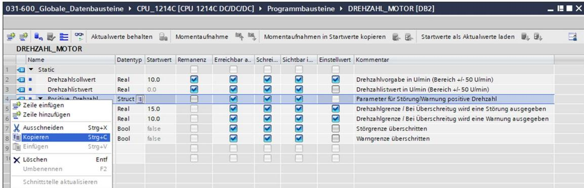
Ⓜ Fügen Sie die kopierte Struktur unterhalb von ‚Positive\_Drehzahl‘ nochmals ein.
