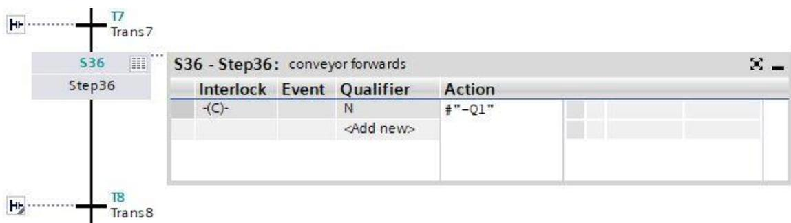
→ 如果已如步骤 31 中所示, 现在必须将
