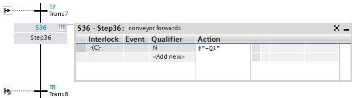
→ Comme indiqué précédemment pour Step31 (étape 31), la condition de verrouillage "-B1" doit maintenant être définie comme Interlock C dans Step32 (étape 32) et Step36 (étape 36) par glisser-déposer dans la vue Etape unique
