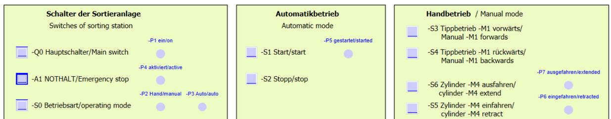
Abbildung 2: Bedienpult
