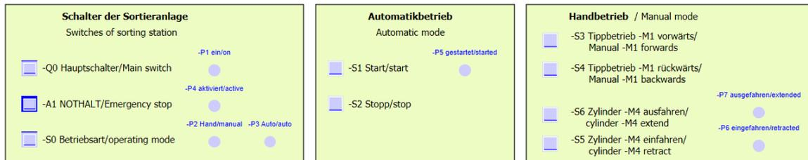
Abbildung 4: Bedienpult
