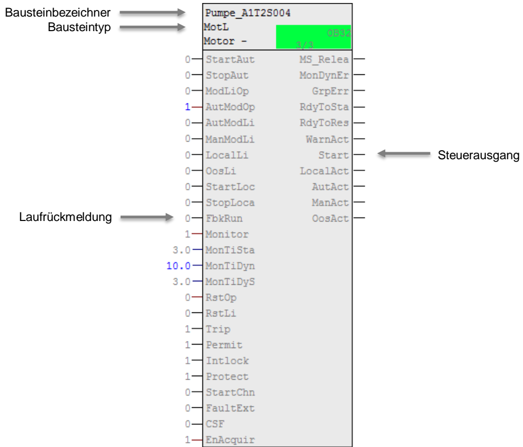
Abbildung 2: Baustein der Einzelsteuerfunktion Motor_Lean
