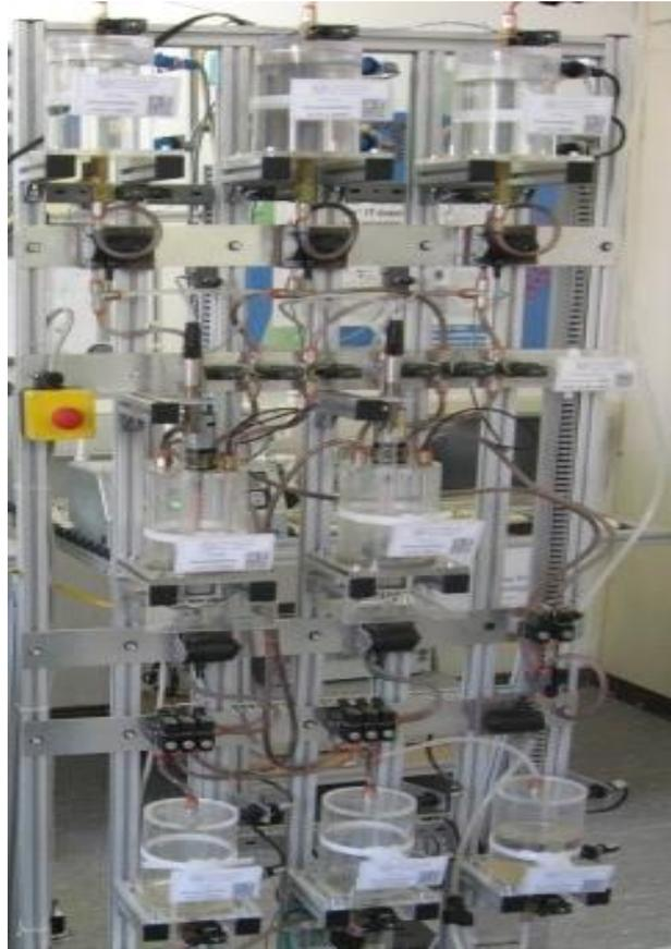
Abbildung 1: Mehrprodukt- und Mehrstrang-Mehrweg-Laboranlage der TU Dresden als Übungsfeld für moderne Prozessleittechnik
