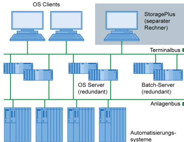
Abbildung 5: Einordnung von Storage Plus in die Leitsystemstruktur [Siemens]
