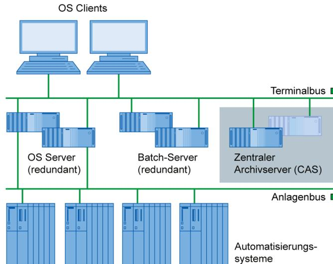
Abbildung 3: Einordnung des zentralen Archivservers in die Leitsystemstruktur [Siemens]
