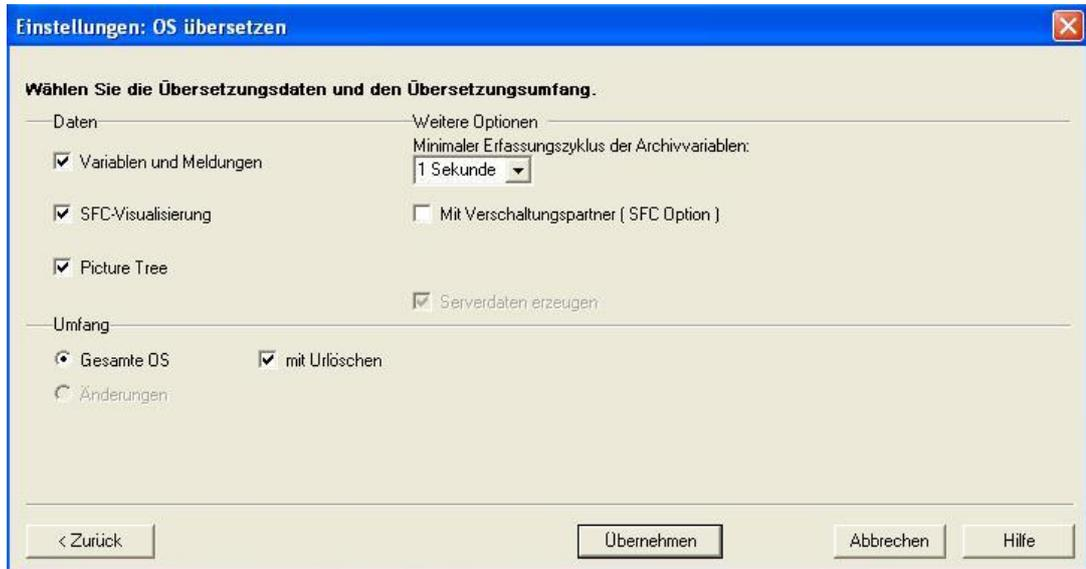
17. Da bei unserer Anlage die Operator Station (OS) auf dem Engineering System (ES) gestartet wird, soll hier nur Übersetzen und nicht Laden angewählt werden. Nach dem Starten des Übersetzungslaufs wird der Hinweis mit Ja bestätigt. ( → Starten → Ja)
