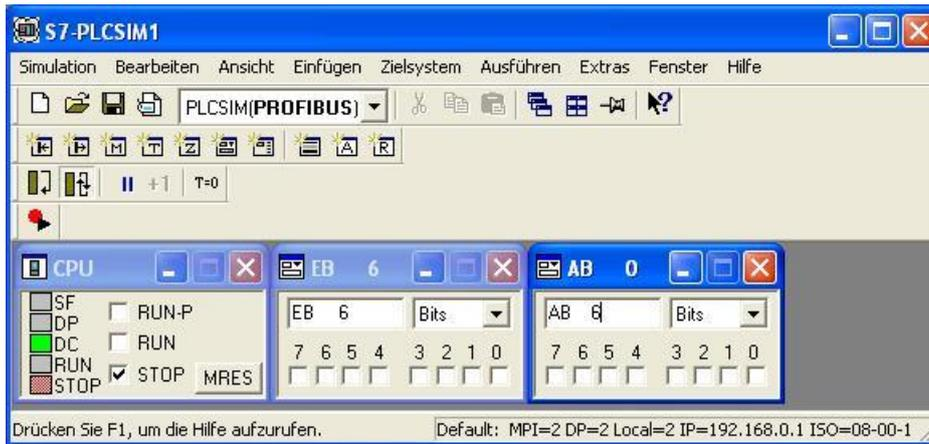
31. Damit aus dem SIMATIC Manager auch über die richtige Schnittstelle in **S7-PLCSIM** geladen werden kann, wird dann noch die PG/PC-Schnittstelle richtig eingestellt.
