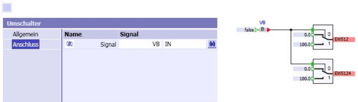
Abbildung 3-6: Mehrfache Verbindungen mit einem Eingabeelement
