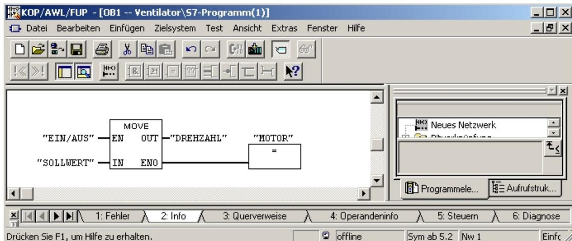
Laden Sie nun das Programm in die SPS-Steuerung und Starten Sie die Simulation in SIMIT SCE.
