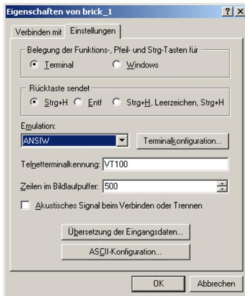
8. Jetzt ist die Verbindung fertig parametrierung und Sie sollten auf die Konsole des ISDN-Routers zugreifen können. Wenn Sie noch keine Login-Meldung im Terminalfenster sehen, drücken Sie die Enter-Taste (→ Enter)
