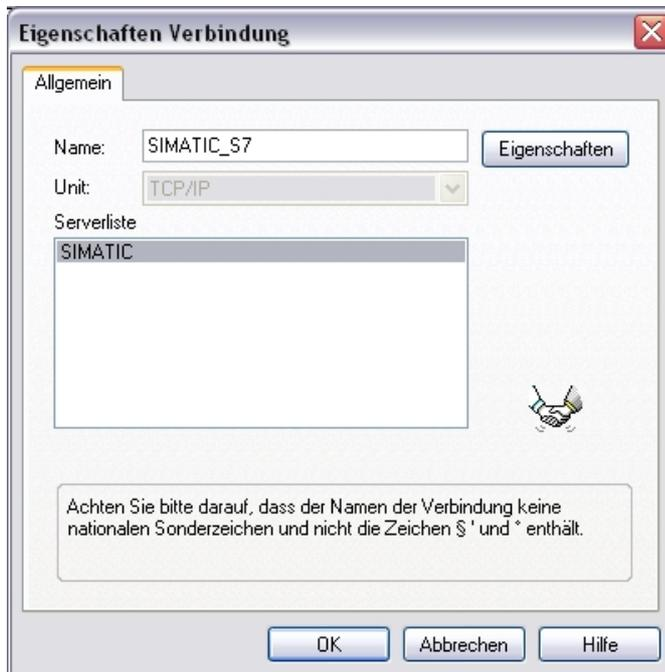
13. Unsere SIMATIC S7- CPU besitzt eine **‚IP-Adresse‘** die mit der Software STEP7 konfiguriert werden kann. Weiterhin ist die Eingabe von **‚Rack-Nr.‘** und **‚Steckplatz-Nr.‘** unter den Eigenschaften der angelegten Verbindung erforderlich.
