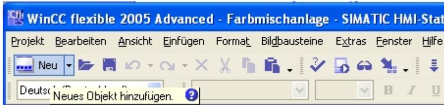
Beim Anlegen eines neuen Projektes werden die Symbolleisten standardmäßig am oberen Bildschirmrand positioniert. Die Position der Symbolleisten ist an den Benutzer gekoppelt, der in Windows angemeldet ist. Wenn Sie Symbolleisten mit der Maus verschoben haben, werden nach dem Start von WinCC flexible die Positionen wieder hergestellt, die die Symbolleisten beim letzten Beenden hatten.
