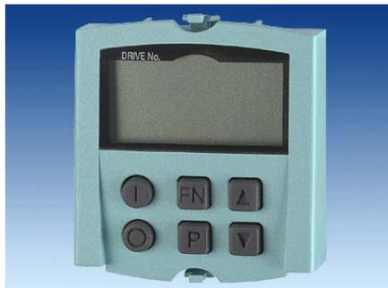
Das Basic Operator Panel BOP20 hat ein zweizeiliges Anzeigefeld mit Hintergrundbeleuchtung und 6 Tasten.
