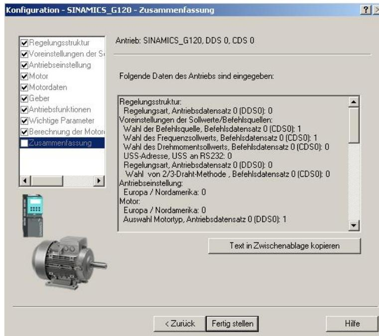
27. Dialoge für die Einstellung von weiteren Parametern können links im Projektbaum per Doppelklick angewählt werden. (→ z.B. Motortemperatur)
