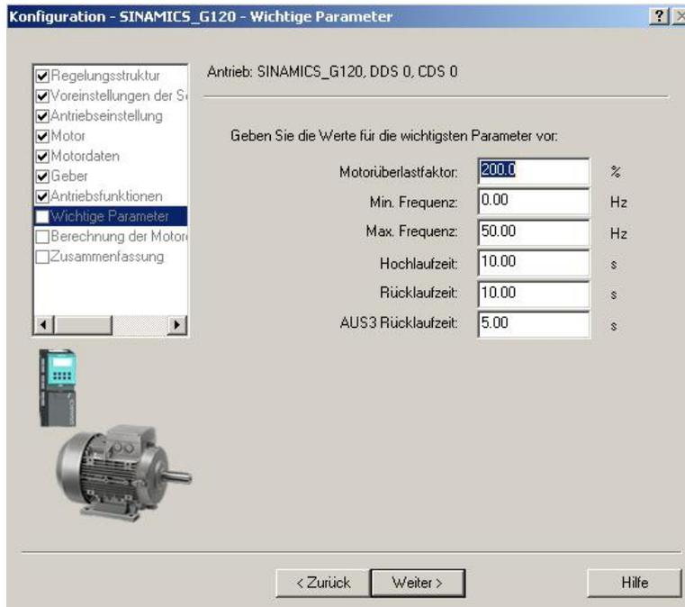
25. Im folgenden Dialog empfiehlt es sich die **Vollständig Berechnung** der Motorparameter zu wählen. (→ Vollständig Berechnung → Weiter)
