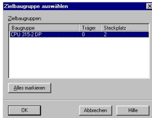
26. Dann wird noch die MPI- Adresse der CPU für den Anschluss der Programmierverbindung mit ,OK' übernommen. ( → OK )
