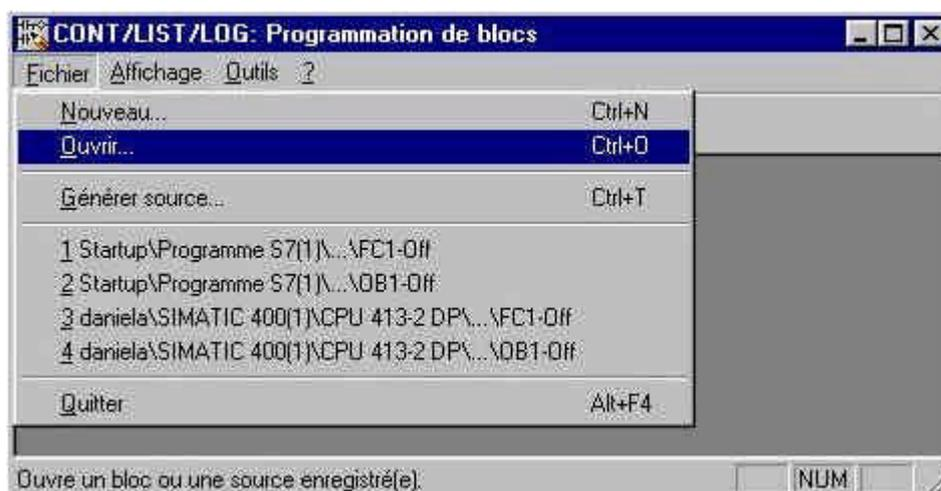
3. Ouvrir les blocs de la CPU '**en ligne**' ou en '**Entité atteignable**' ( → Entrée : Projet → Blocs → En ligne → Sélectionner un bloc → OK).
