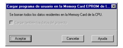
4. Si el mismo programa necesita ser ejecutado en una segunda CPU, dicha CPU deberá apagarse antes de introducir la Memory Card. Tras encender la CPU y pasarla a modo RUN, se lleva a cabo un borrado de memoria en la memoria de la CPU.
