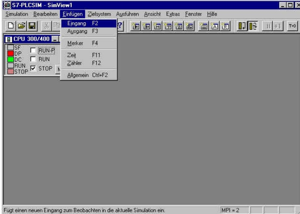
10. Las direcciones deseadas, se han de registrar en **,EB0'** y **,AB4'** y se ha de elegir su valor en **,Bits'**. (→ EB0 → Bits → AB4 → Bits)
