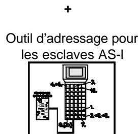
L'interface AS est un système monomaître. Par conséquent, dans un système à CP342-2, il existe toujours exactement un maître et jusqu'à 31 esclaves. Si on a besoin de plus d'esclaves, on doit mettre en place un autre système d'interface AS avec un autre maître.
