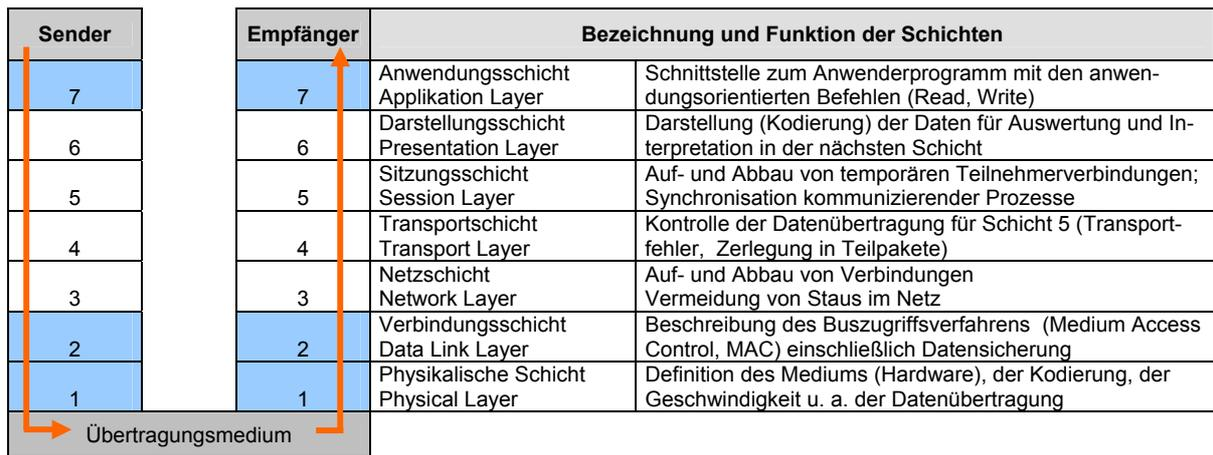
Abbildung 2: Das OSI-Schichtenmodell
