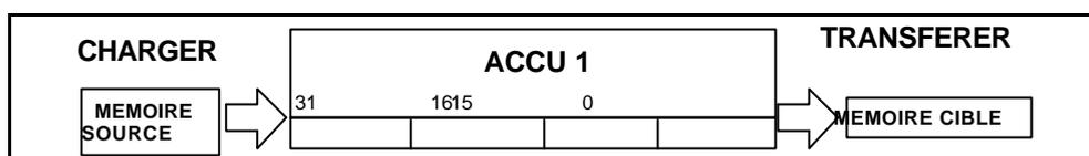
Lors du chargement, le contenu de la mémoire source désignée est copié et écrit dans l'ACCU 1. Le contenu s'y trouvant jusque là est transmis à l'ACCU 2.
