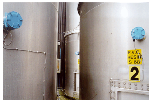
Milltronics Mercap misst den Füllstand von staubigem PVC Pulver, um maximale Produktionseffizienz bei Anglian Windows zu garantieren.
