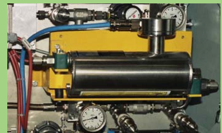
Der MASS 2100 Coriolis-Durchflussmesser das auf dem FuelRate Messteil des Motoren-Prüfstands installiert ist.
