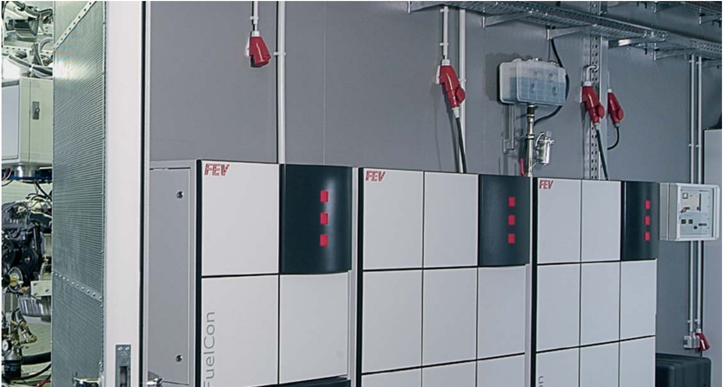
Ein kompletter Motoren-Prüfstand von FEV ist ca. 8 Meter (26.25 Fuß) lang und 5 Meter (16.40 Fuß) breit und enthält bis 4 MASSFLO Coriolis-Durchflussmesser und MASS 6000 Messumformer.
