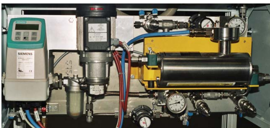
Der FuelRate Messteil des Motoren-Prüfstands besteht rechts aus einem MASSFLO Coriolis-Durchflussmesser und links aus einem MASS 6000 Messumformer.
