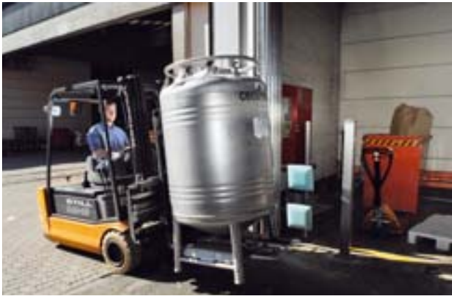
RFID-Station am Wareneingangstor: An dieser Station werden alle relevanten Daten der eintreffenden Leergut-Container erfasst und an das MES weitergeleitet.
