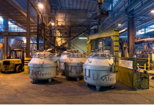
Das Aluminium wird flüssig in speziell isolierten Tiegeln transportiert.
