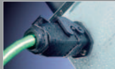
Für die raue Industrieumgebung: Access Point in hoher Schutzart IP67
