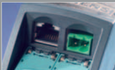
Für gute Verbindungen: Strom- und LAN-Anschluss am Power Insert
