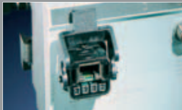
In allen Details durchdacht: Port mit Push Pull-Technik für IP67
