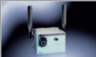
Zwei Antennen für Diversity: Zuverlässiges Senden und Empfangen
