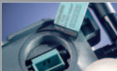
Für schnellen Start nach Gerätetausch: C-PLUG speichert Gerätedaten
