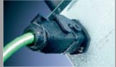
Für die raue Industrieumgebung: Access Point in hoher Schutzart IP65
