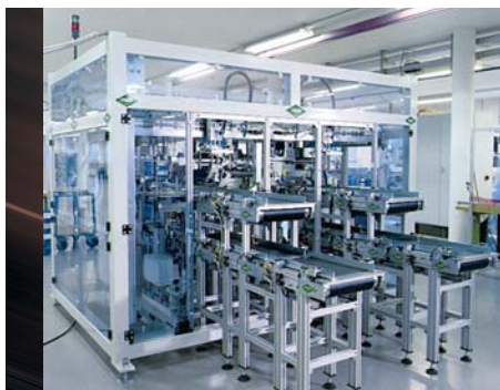
Die Synchronisierung der zahlreichen kurzen Transferbänder übernehmen Frequenzumrichter Sinamics G110
