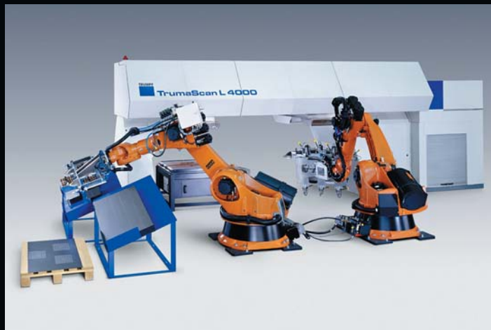
Das neue Remote-Laser-Schweißsystem von Trumpf eröffnet neue Perspektiven im Karosserie-Rohbau
