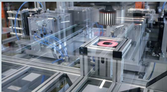
In einem Arbeitsgang prüft der Vision Sensor Simatic VS120 Drehung und Qualität des Stators, in den die Papierisolierung automatisch eingelegt werden soll
