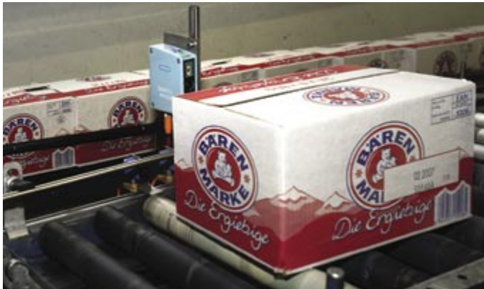
Fünf Produktionslinien liefern pro Minute bis zu 40 Kartons unterschiedlicher Größe und Farbe, die im Kartonbahnhof sicher erkannt und in die richtigen Wege geleitet werden müssen.
