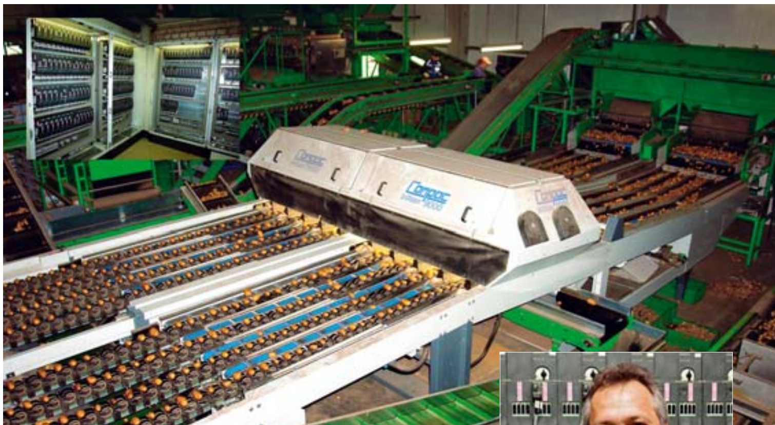
Zum Sortieren, Waschen und Verpacken von Bio-Kartoffeln wurde bei Agrata eine eigene Anlage gebaut, bei der rd. 120 Antriebe über High-Feature-Motorstarter vom Typ Simatic ET200S gestartet werden
